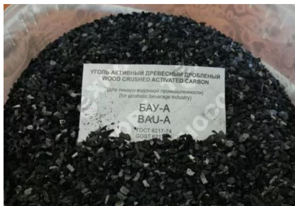
Сурет 2 – БАУ-А маркалы активтендірілген көмір және Фенолдық антиоксидант – бутилгидрокситолуол
