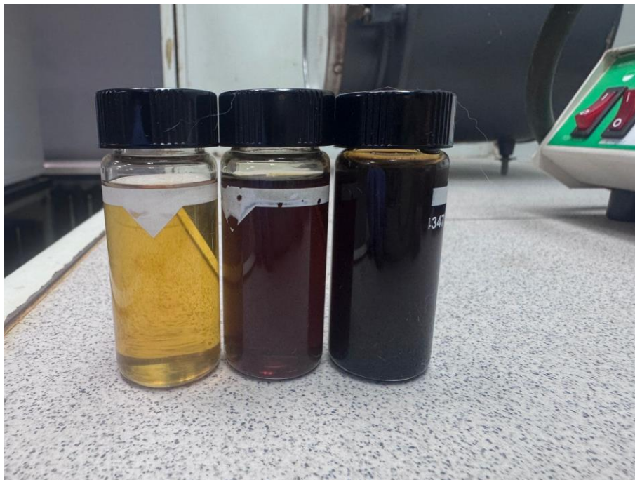
Сурет 12 – Термооксидативті өндеуден кейінгі мотор майы үлгілерінің сыртқы көрінісі
